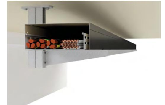
Abgehängte Montage mit sehr großer „Spannweite“ von bis zu 2100 mm. Die Kabel dürfen mit oder ohne Kabelrinne verlegt werden. Ebenfalls ist eine Variante mit seitlich verschraubtem Deckel möglich.
